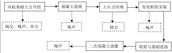
1.2 箱式变压器组工程工艺流程及产污环节
